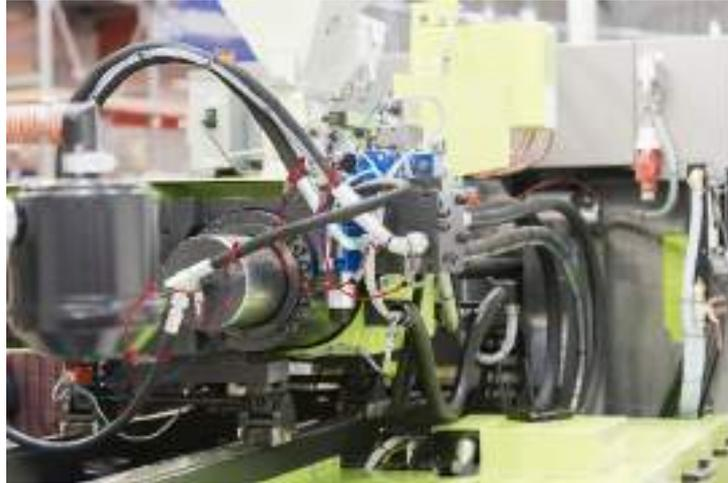
Si tratta di uno speciale sistema di bloccaggio per tubi flessibili alta pressione che garantiscono il trattenimento degli stessi in caso di sfilamento del raccordo. Il cavo va opportunamente scelto in base alle pressioni massime di esercizio del flessibile.
