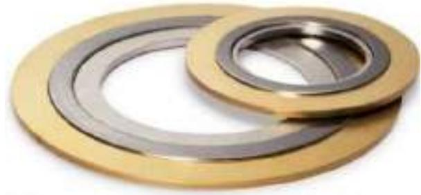
Le guarnizioni spirometalliche devono essere sempre in contatto con la flangia e non devono sporgere nel tubo o dalla flangia. Possono essere rinforzate con un anello di centraggio esterno e / o anello di sicurezza interno. L'anello di centraggio esterno controlla la compressione e tiene le guarnizioni in posizione centrale all'interno della bulloneria. L'anello di sicurezza interno aumenta la rigidità assiale e la resilienza della guarnizione.
