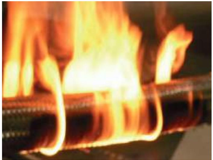
**MB LUBE-OIL SILVER 301** soddisfa completamente le caratteristiche tecniche previste dagli standard della **DIRETTIVA 96/98/CE** e successivi emendamenti **ISO 15540:1999** e **ISO 15541:1999** che ne determinano i parametri. Il tubo flessibile in gomma ha rinforzi in acciaio ed è ricoperto esternamente da una calza di rinforzo in acciaio inox AISI 304 che protegge la tubazione e garantisce un'elevata resistenza meccanica della stessa.
