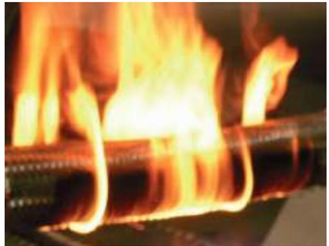
**MB LUBE-OIL PLATINUM 42** soddisfa completamente le caratteristiche tecniche previste dagli standard della **DIRETTIVA 96/98/CE** e successivi emendamenti **ISO 15540:1999** e **ISO 15541:1999** che ne determinano i parametri. Il tubo flessibile in gomma ha rinforzi in acciaio ed è ricoperto esternamente da una calza di rinforzo in acciaio inox AISI 304 che protegge la tubazione e garantisce un'elevata resistenza meccanica della stessa.
