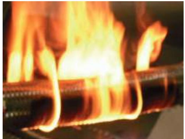
**MB LUBE-OIL GOLD 31** soddisfa completamente le caratteristiche tecniche previste dagli standard della **DIRETTIVA 96/98/CE** e successivi emendamenti **ISO 15540:1999** e **ISO 15541:1999** che ne determinano i parametri. Il tubo flessibile in gomma ha rinforzi in acciaio ed è ricoperto esternamente da una calza di rinforzo in acciaio inox AISI 304 che protegge la tubazione e garantisce un'elevata resistenza meccanica della stessa.
