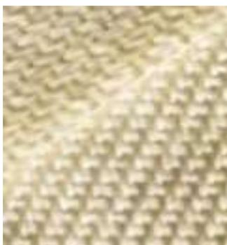
Tessuto costituito di filato di vetro. È ottenuto da filamento continuo testurizzato. Presenta valida resistenza a punte di temperatura elevata conservando flessibilità e proprietà meccaniche. Offre ottime caratteristiche di resistenza alla trazione ed alle vibrazioni, elevata stabilità chimica nei confronti di oli, carburanti e della maggior parte degli agenti corrosivi.
