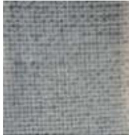
Ottenuto con filati di fibre P.A.N (PoliAcridoNitrile), miscelate con fibre sintetiche ad alta resistenza meccanica. Ha elevate proprietà termoisolanti, è ininfiammabile e non fonde. Spalmato su un lato con gomma naturale non vulcanizzata.
