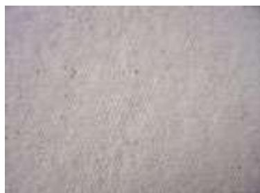
Cartone isolante esente amianto e da fibre ceramiche refrattarie. Si presenta sottoforma di pannelli rigidi ad elevata densità adatti a varie applicazioni per la tenuta e la resistenza al calore.
