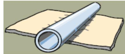
Sagomare il foglio tagliandolo a misura e avvolgerlo attorno alla superficie da isolare. Fare in modo che le due estremità vengano a contatto e apporre il nastro adesivo per sigillare la copertura. Per rimuovere la copertura sarà sufficiente tagliare il nastro e rimuovere il foglio di **MB EXOWRAP**. Per riutilizzare la copertura così rimossa è necessario sostituire il nastro adesivo di fissaggio.
